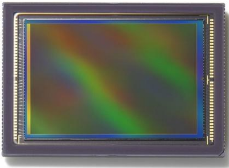
Foto: svjetlosni senzor ili čip zamijenio je film iz analognog fotoaparata
